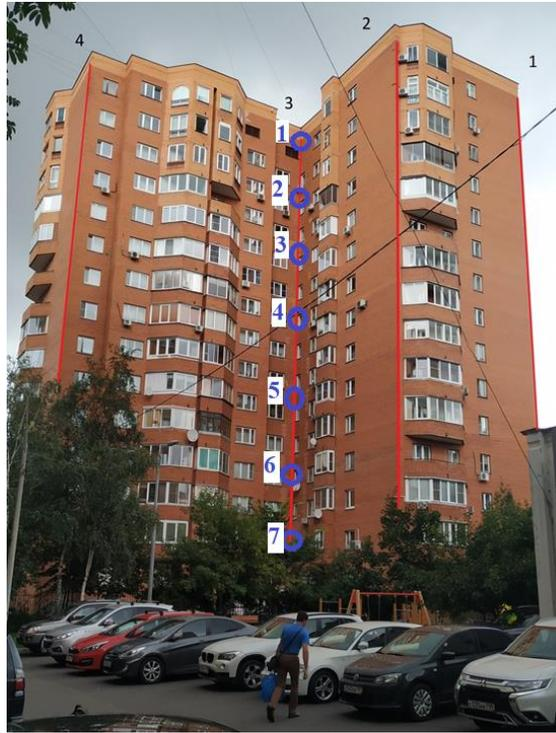
Рис. 2.1. Геодезические измерения снаружи здания (красными линиями показаны оси измерения, а синими кружками – точки измерений)
