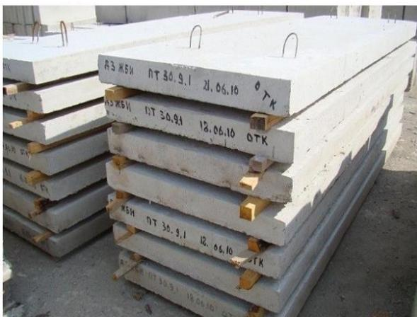
Рисунок 3 – Сплошные железобетонные плиты
