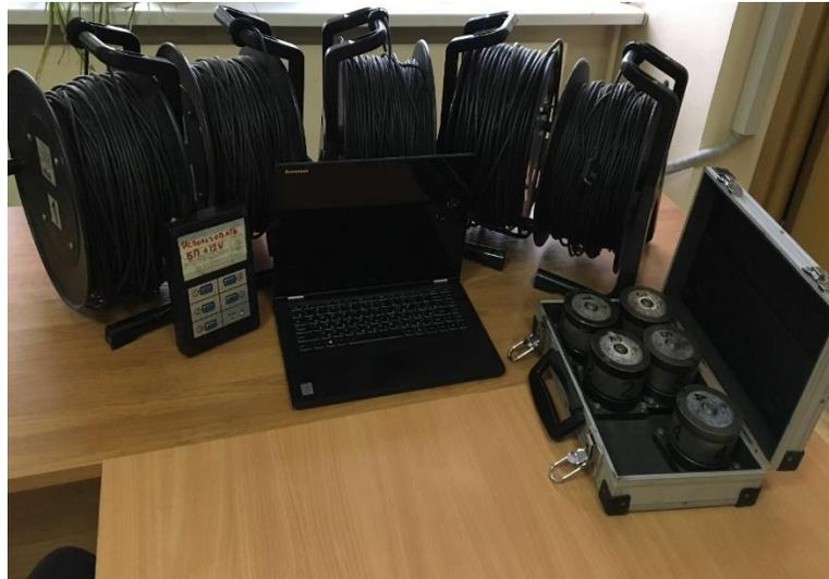
Фото 2.1. Состав комплекса «Струна» для динамико-геофизических испытаний системы «грунт-здание»
