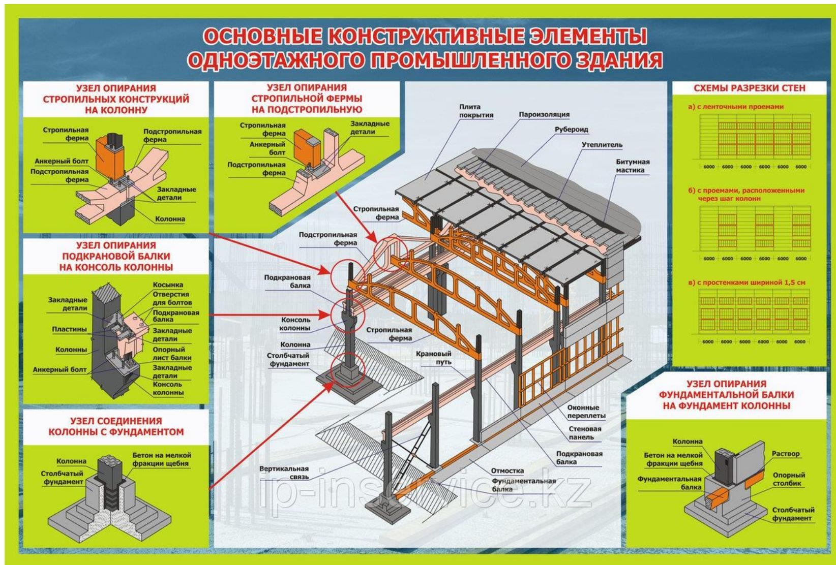
Рисунок 2.4. Основные конструктивные элементы одноэтажного промышленного здания
