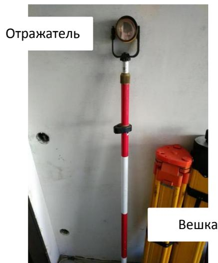
Фото 2.2. Вешка геодезическая с отражателем
