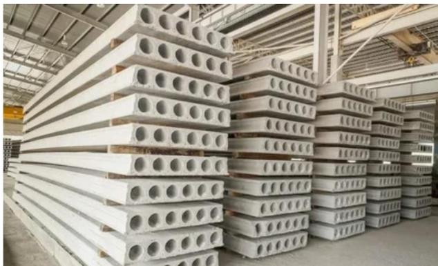
Рисунок 1 – Пустотные железобетонные плиты
